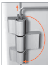
Verstellstern entnehmen und in unteres Bandteil einsetzen.
